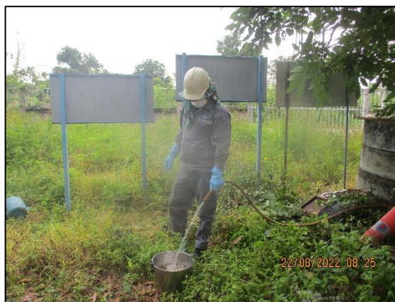
รูปที่ 3.17 การเก็บตัวอย่างคุณภาพน้ำใต้ดิน บริเวณชุมชนห้วยสะพาน (GW6)
