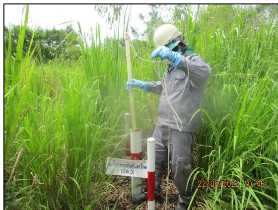
รูปที่ 3.14 การเก็บตัวอย่างคุณภาพน้ำใต้ดิน บริเวณพื้นที่โครงการด้านทิศตะวันตก (GW3)
