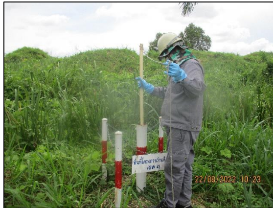
รูปที่ 3.15 การเก็บตัวอย่างคุณภาพน้ำใต้ดิน บริเวณพื้นที่โครงการด้านทิศตะวันตก (GW4)
